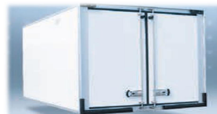
Композитні панелі (харчовий гелеобразний шар - полієфір - поліуретан), оснащені алюмінієвими вставкам
